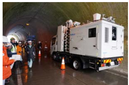
非接触レーダーなどを搭載した車両
