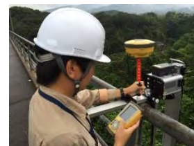
GPS機器と点検ロボットカメラの連動
