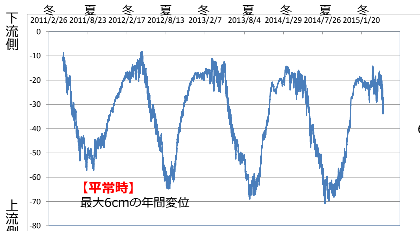
アーチ式コンクリートダムの上下流方向の変位量の例 (上図の変位はダムの安全性には影響はありません)
