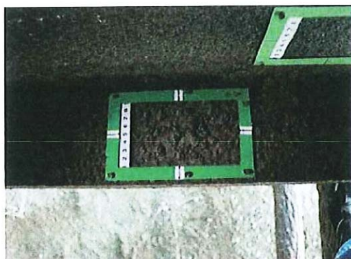
写真3 経過17年 さびの大きさが最大5mm以上で粗く凹凸が大きい
