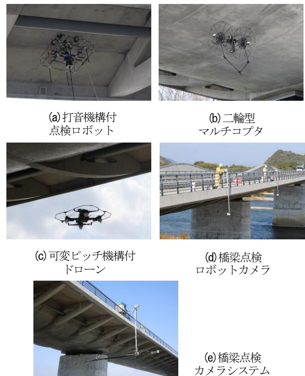
図-5 適用予定の橋梁点検用ロボット技術
