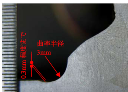
写真-1 止端仕上げの断面
