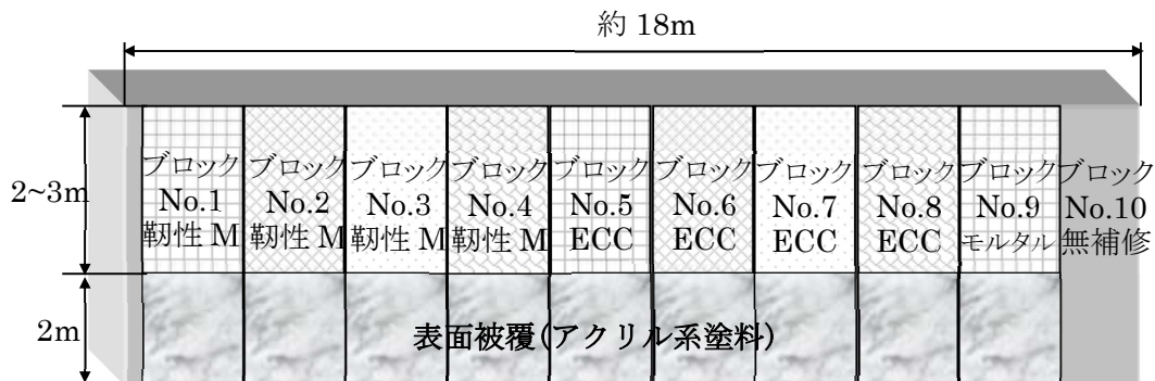
図-1 当初吹付け施工時の擁壁の分割
