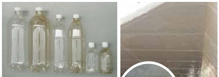
図-1 DLC コーティングした PET ボトル (それぞれ左側が通常のボトルで右側がコーティングされたボトル) ならびに DLC シートを貼り付けたコンクリート構造物の例 (積水化学パンフレットより)
