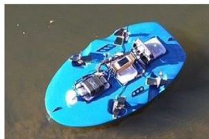
JIW 社が開発したソナー付き全方向水面移動式ボート型ドローン（特許取得済）
