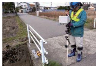
橋面・ガードレール撮影状況
